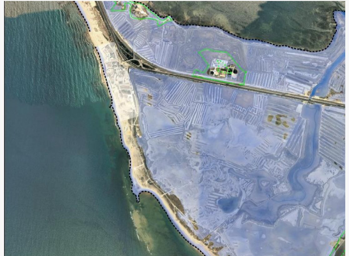
Mapas de peligrosidad y riesgo requeridos por el RD 903/2010 en la costa española (T=100 años). MAGRAMA, 2013.
