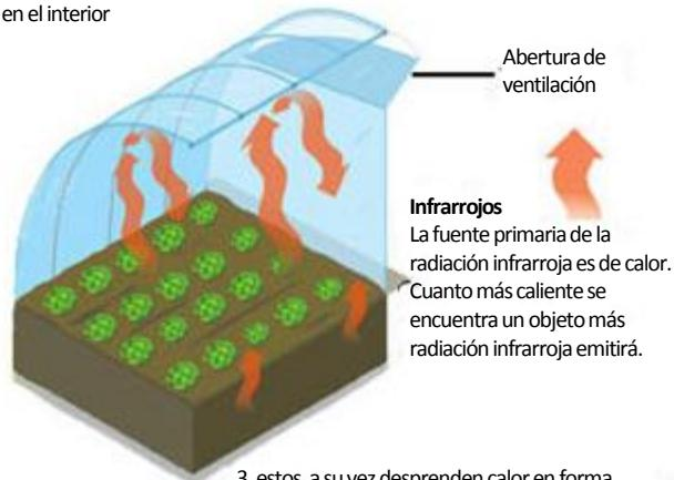
3. estos, a su vez desprenden calor en forma de rayos infrarrojos de onda larga (invisibles) que refractan (rebotan) en el recubrimiento y aumentan la temperatura interior.
