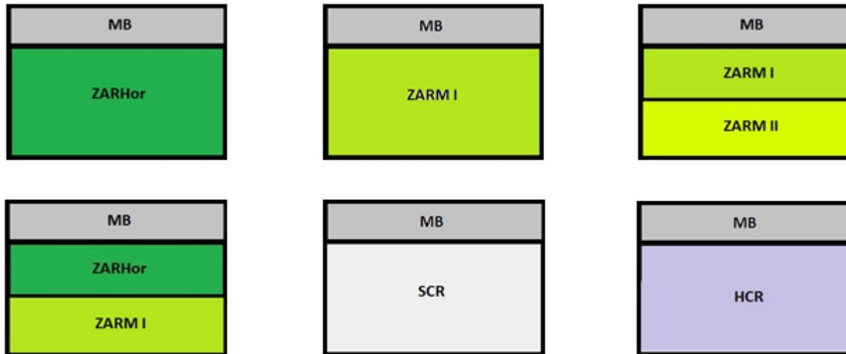
**ILUSTRACIÓN 2. TIPOS DE SECCIONES ESTRUCTURALES RECOMENDADAS PARA EL USO DE ÁRIDOS DE RCD**
