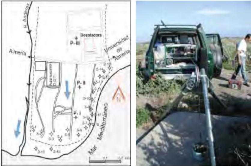
Figura 65. Desaladora de agua de mar de Almería y situación de los sondeos de captación (S-1 - S-19) y de los tres grupos de piezómetros (P-I, P-II y P-III) de control y seguimiento del contacto agua dulce-agua salada. Las flechas indican el sentido del flujo subterráneo; en la foto, testificación en un piezómetro realizado en el entorno de la desaladora
